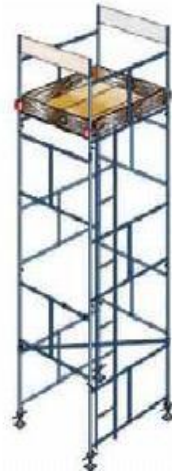
Ilustração 19.16.10: Trava em roda de andaime móvel.
